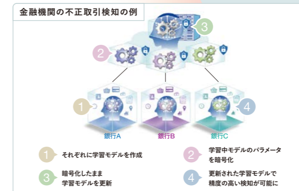
個人情報など機密性の高いデータを開示せずに、複数組織で共同のデータ解析を可能にするDeepProtect
